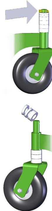
Il est plus facile d'ajuster la hauteur lorsque l'accessoire est légèrement soulevé du sol avec le chargeur.
